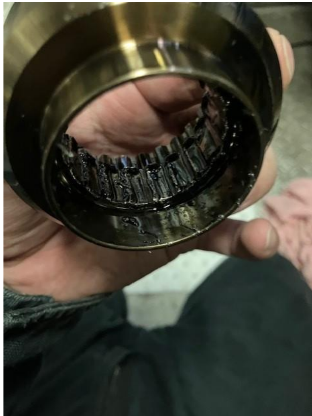
写真2 スプラインギア損傷状況
