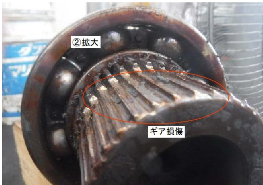
写真4 スプラインギア損傷状況
