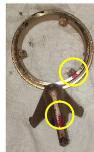
写真2 弁座の破損状況
