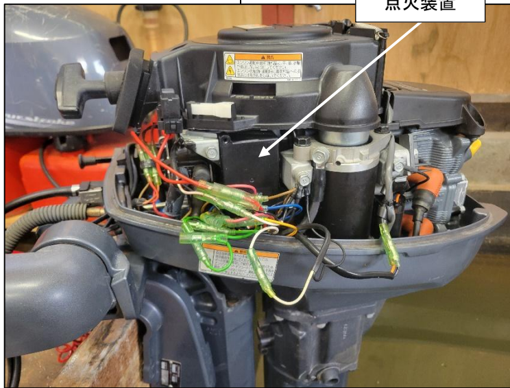
写真 1 点火装置の取付箇所
