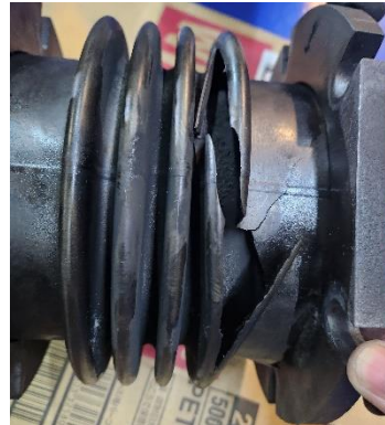
写真1 本件伸縮継ぎ手のベローズ
