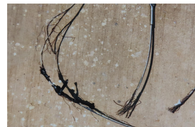
破断したワイヤの一部
