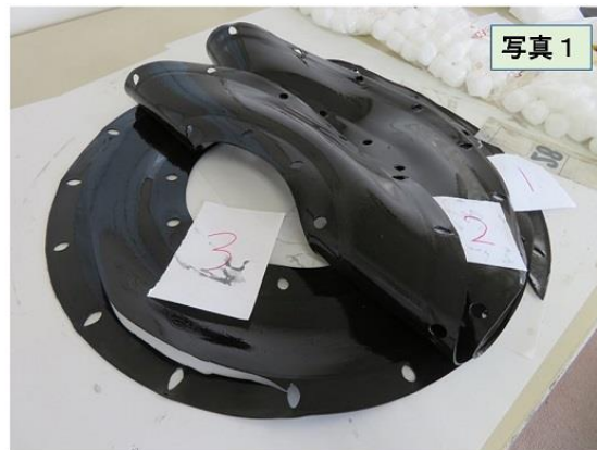
破損したRDS（主機クランク室中央部）
