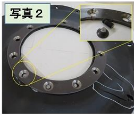
RDS締付金物（リング）及び六角穴付皿ビスに破損
