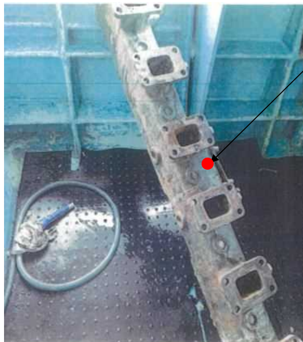
写真2 冷却排気集合管
