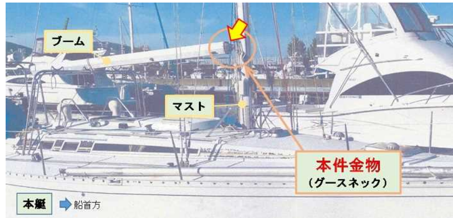
写真1 本件金物の設置場所
