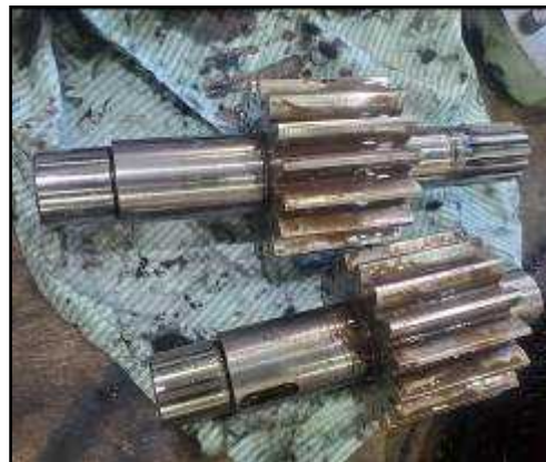
写真2 逆転減速機のクラッチ作動油ポンプ
