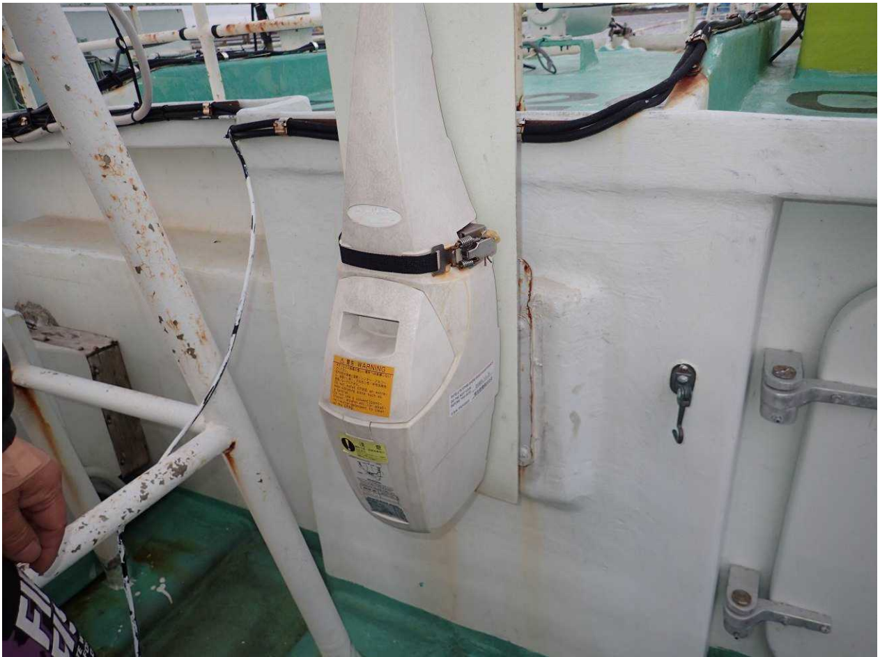
写真 5 非常用位置指示無線表示装置
