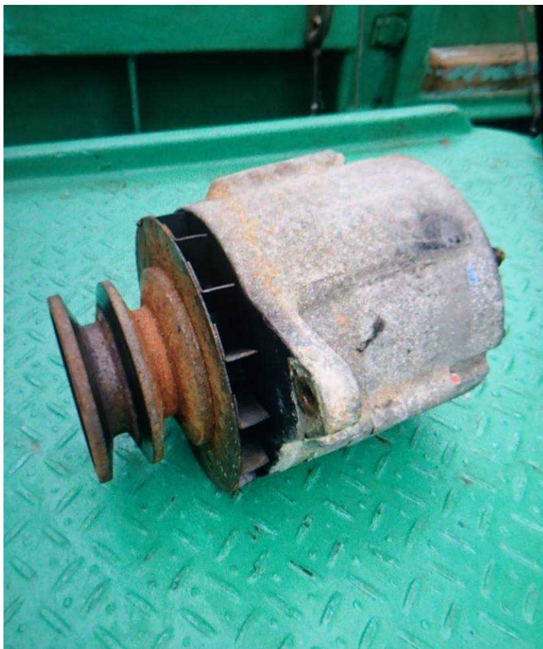
写真4 バッテリー充電用発電機
