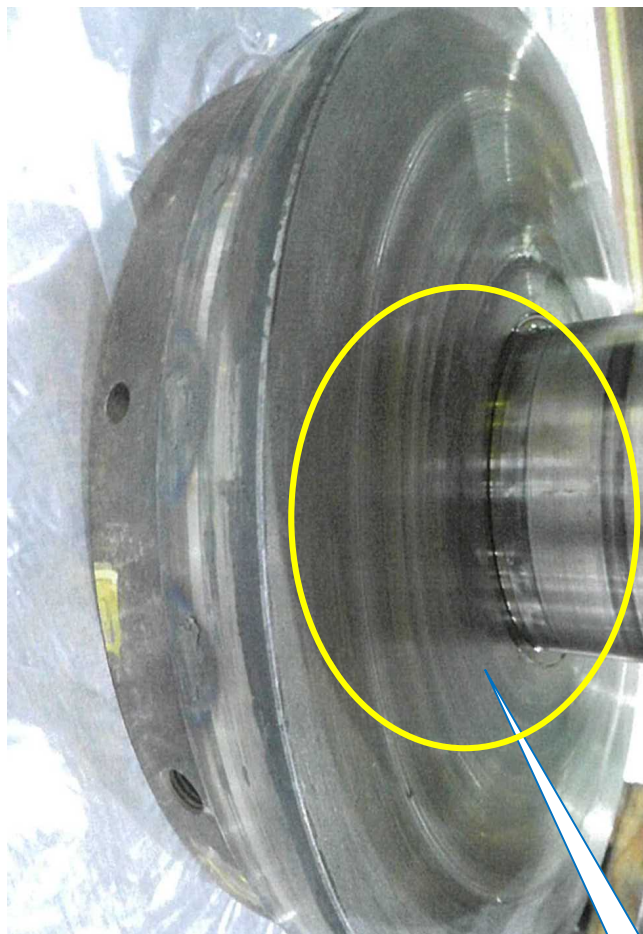
写真5 出力軸前進スラスト面
