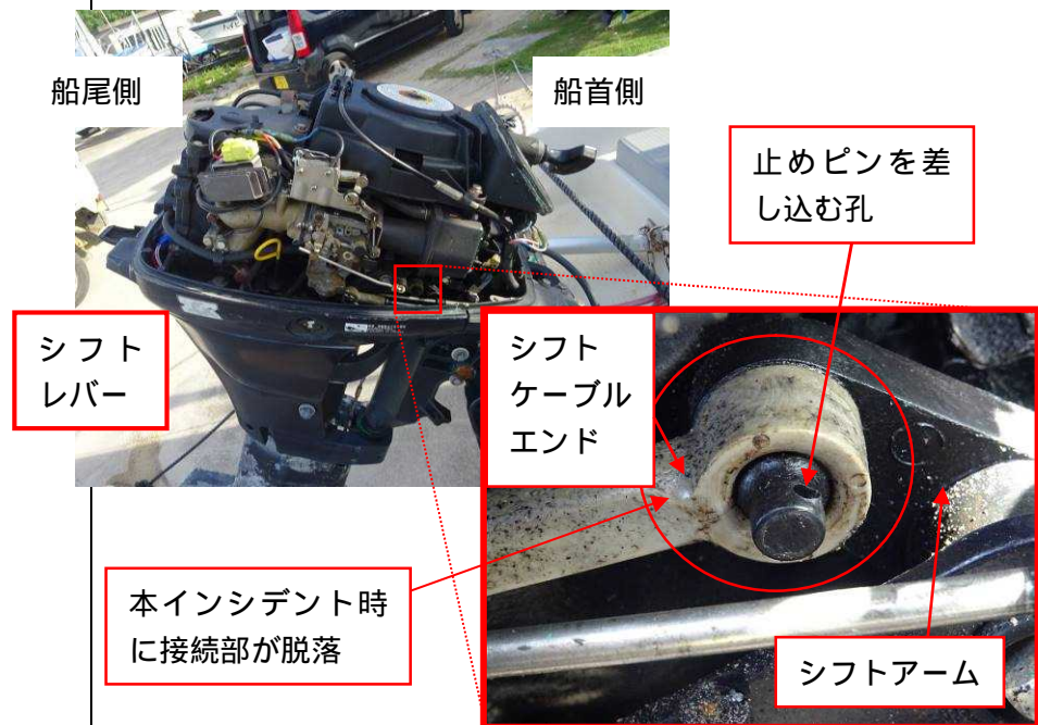
写真1 シフトアームとシフトケーブルの接続部
