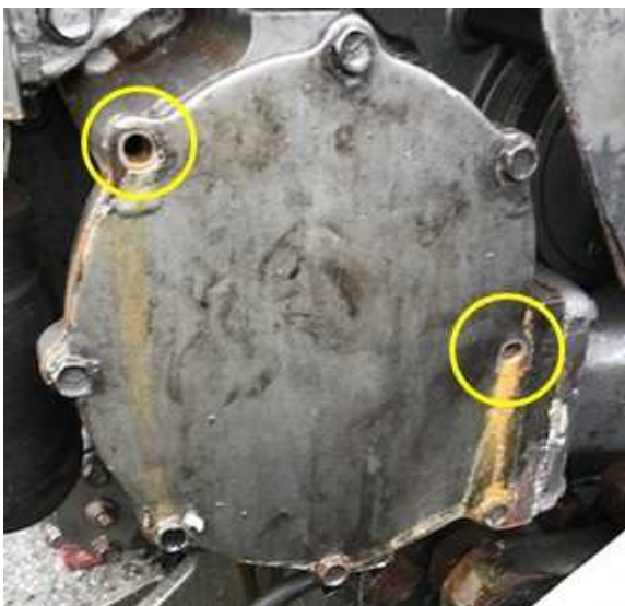
写真4 機付冷却清水ポンプの カバー締付けボルトの欠損
