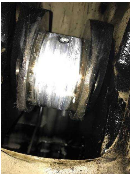
写真1 クランク軸破損状況
