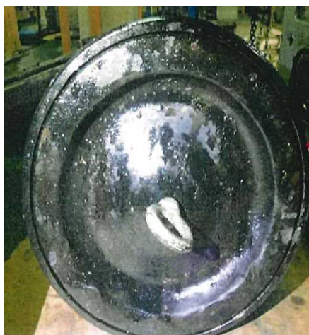
写真1 ピストンクラウンのトップランドとプロテクトリングの固着
