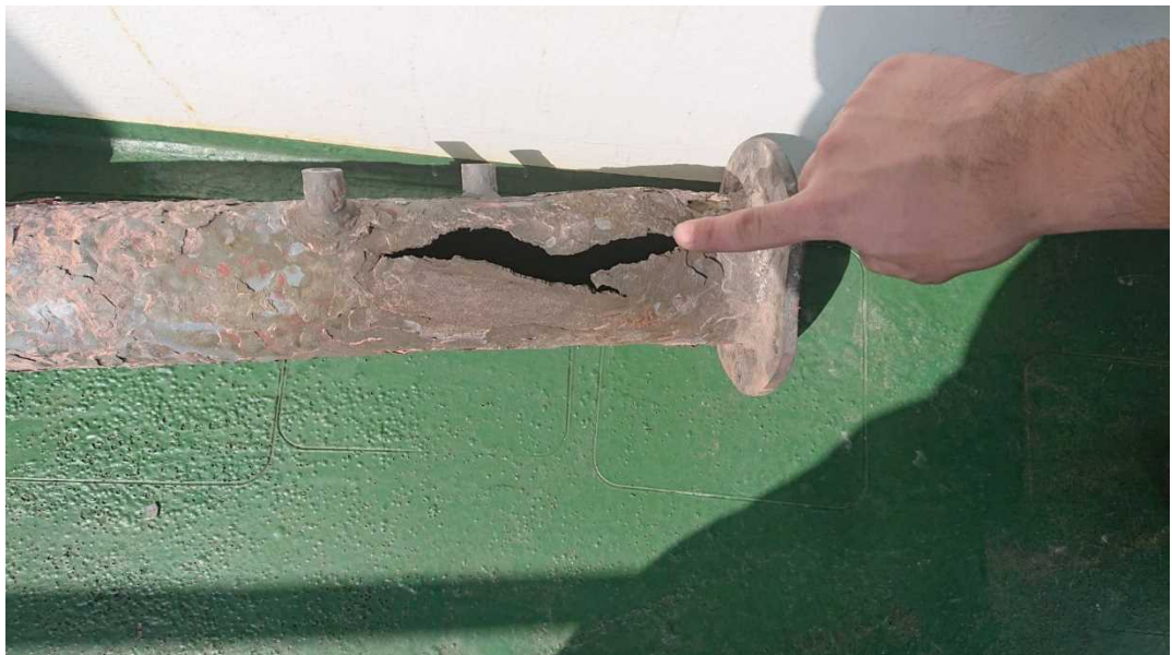
写真1 本件排気管の破口状況
