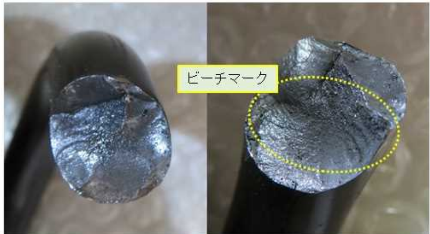
写真2 本件バネの破断面
