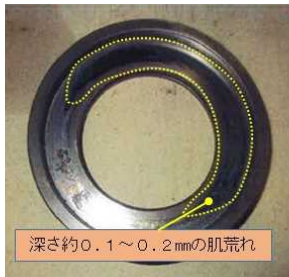
写真3 上部バネ受皿の接触面の状況
