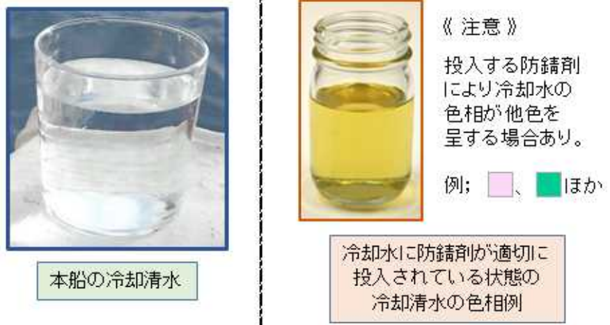
図2 本船の冷却清水と適切な状態との比較
