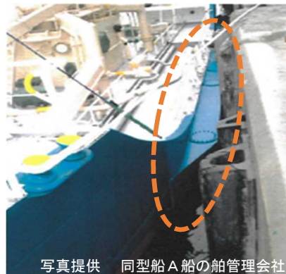
写真3 同型船Aに設置された船側バルジ
