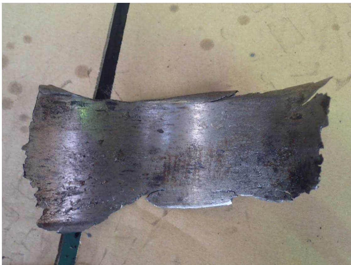
写真3 3番シリンダのクランクピンメタル
