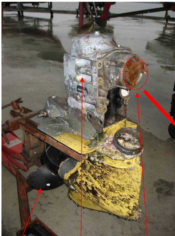
プロペラ アウトドライブ 中間軸のヨーク部
