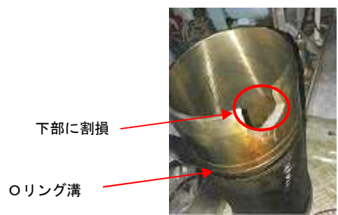
写真5 右舷主機A7のシリンダのシリンダライナ
