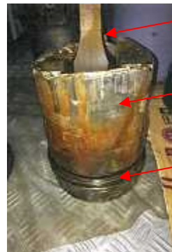
写真3 本件シリンダのピストン
