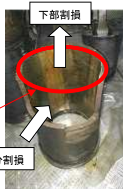
写真2 本件シリンダのシリンダライナ
