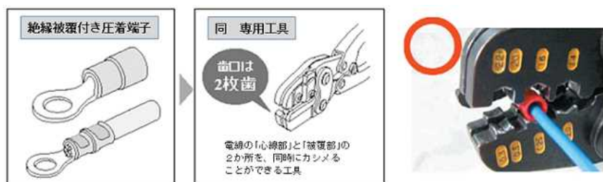
図2 絶縁被覆付き圧着端子の正しいカシメ方
