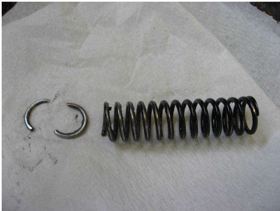
写真3 折損したバネの状況
