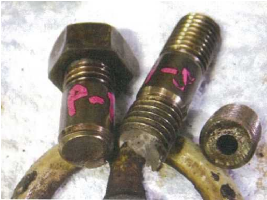
写真5 折損した本件ポンプ取付用スタッドボルト
