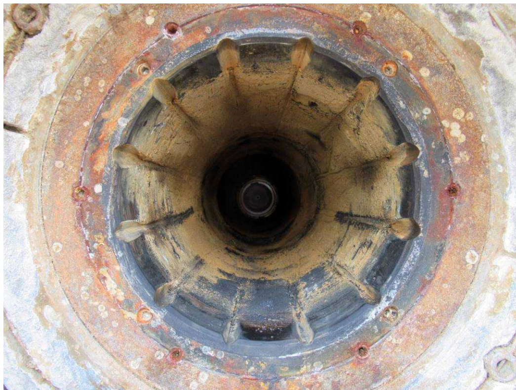
写真3 船外側船尾管軸受の損傷状況
