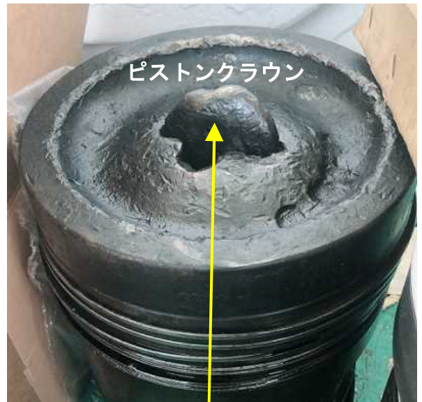
写真3 ピストンクラウン破損状況
