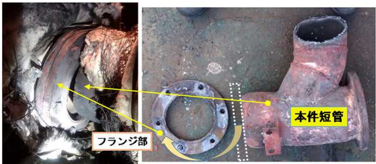
写真1 本件短管の破断状況
