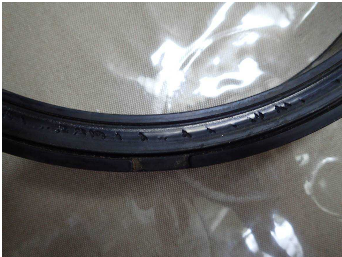
写真5 本件リング損傷状況
