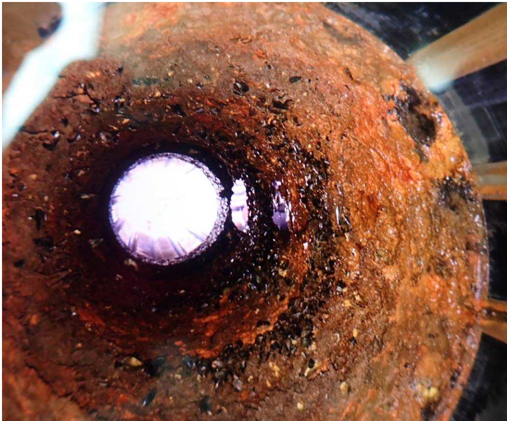
写真2 船尾管内の汚損状況
