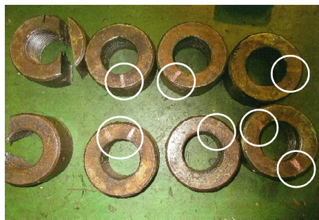
写真11 3番シリンダの締付ナットの合いマークの状況
