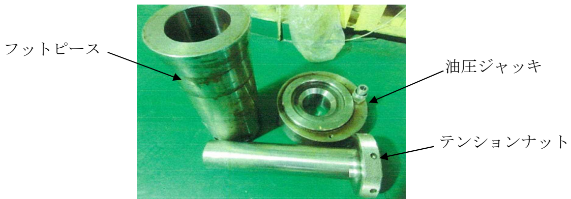
写真8 油圧ジャッキ等
