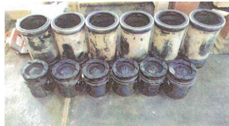
写真1 焼付いたピストン及びシリンダライナ
