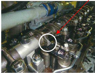
写真1 2番シリンダ ロッカーアーム折損状況
