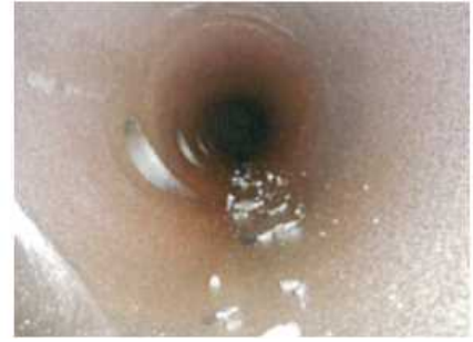
写真3 ピストンの破損状況 写真4 吸気管内の破損片 (付図1 インシデント発生場所概略図 参照)
