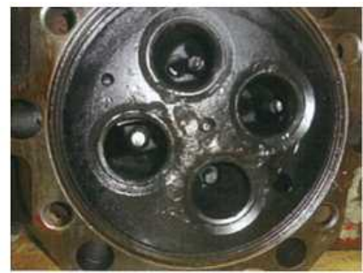
写真2 シリンダヘッド燃焼面の打痕
