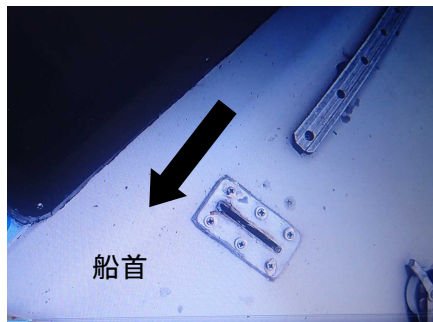
写真2 破断したチェインプレート
