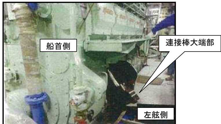
写真1 主機5番シリンダのクランク室付近の状況
