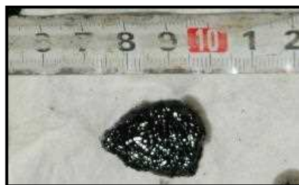
写真1 クランク室の底部にあったカーボン
