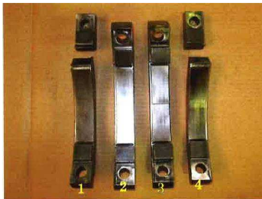
写真6 コッタの折損
