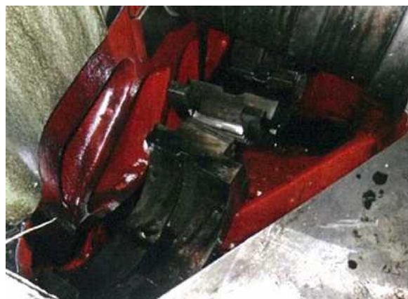
写真1 クランク軸歯車の脱落状況
