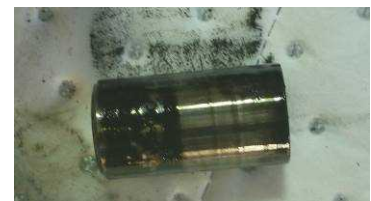
写真1 開放後の潤滑油ポンプ付安全弁 写真2 カーボン付着状況
