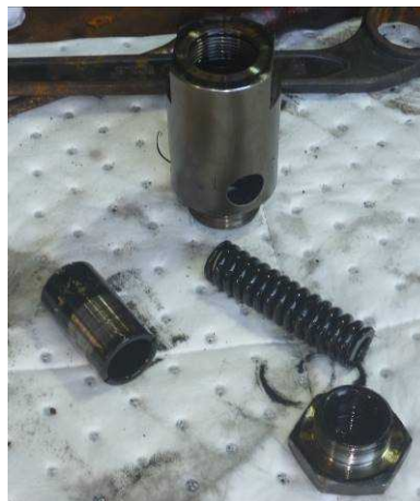
写真1 開放後の潤滑油ポンプ付安全弁 写真2 カーボン付着状況
