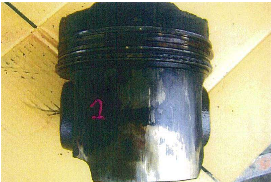
写真1 2番シリンダのピストンの焼損状況
