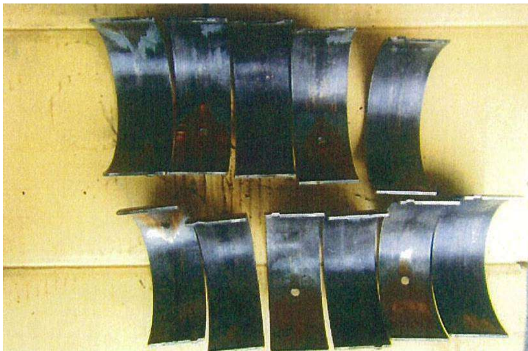
写真3 クランクピンメタルの焼損状況
