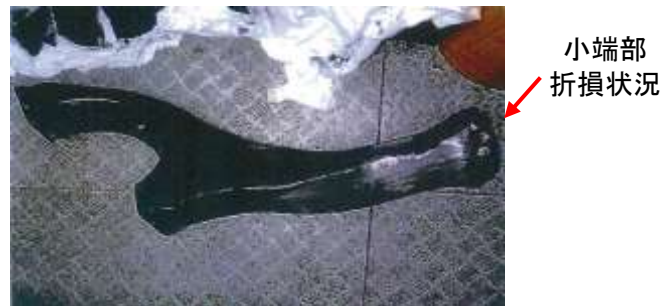
写真2 1番シリンダ連接棒破損状況
