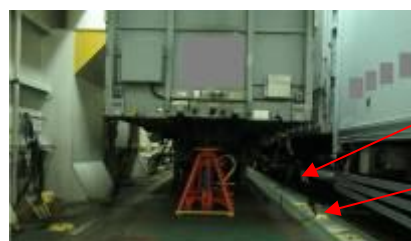
写真2 セミトレーラの固縛状況
