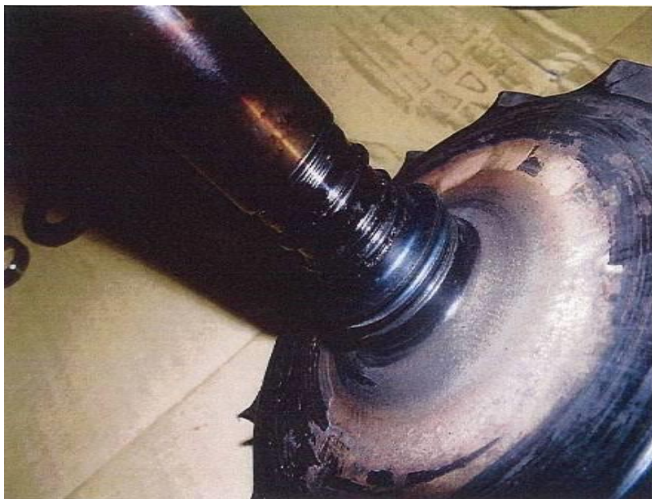
写真4 過給機タービン軸の焼損状況
