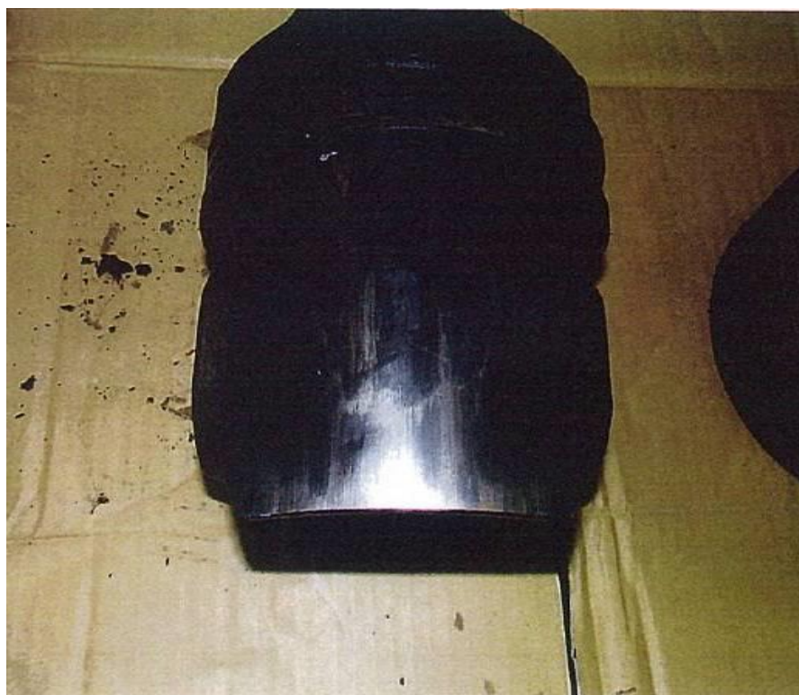
写真2 1番シリンダのピストンの焼損状況
