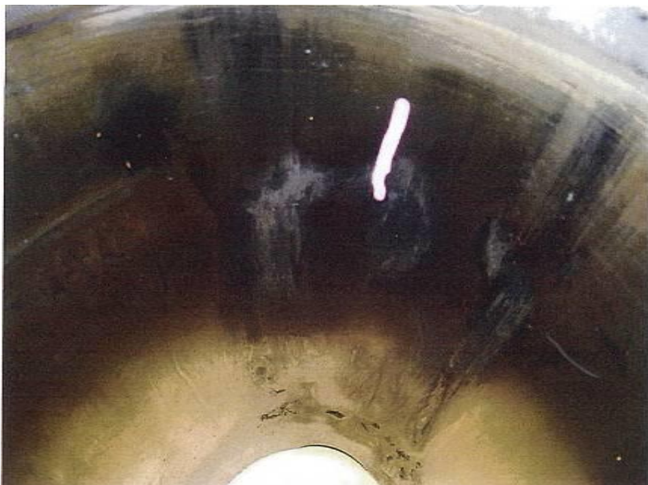
写真3 1番シリンダのシリンダライナの焼損状況
