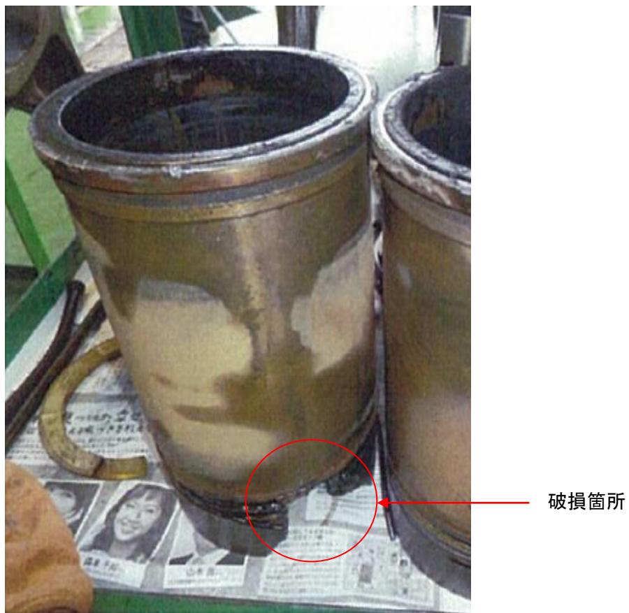
写真3 4番シリンダのシリンダライナの破損状況
