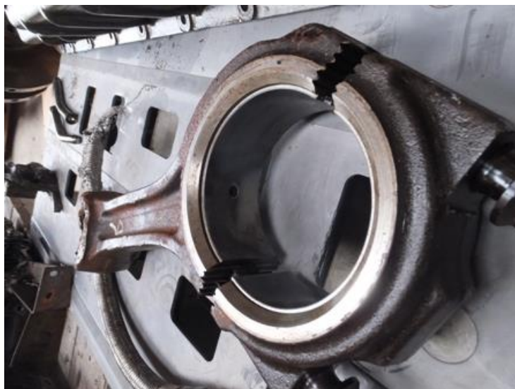
写真11 健全な接続棒大端部
