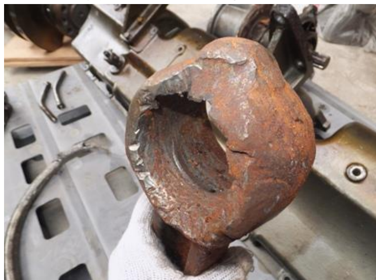
写真12 破損した接続棒小端部
