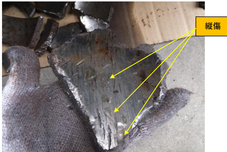
写真7 破損したシリンダライナ内面②
