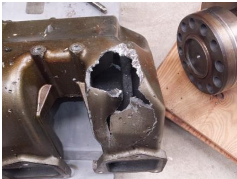
写真 1 3 破損した給気管
