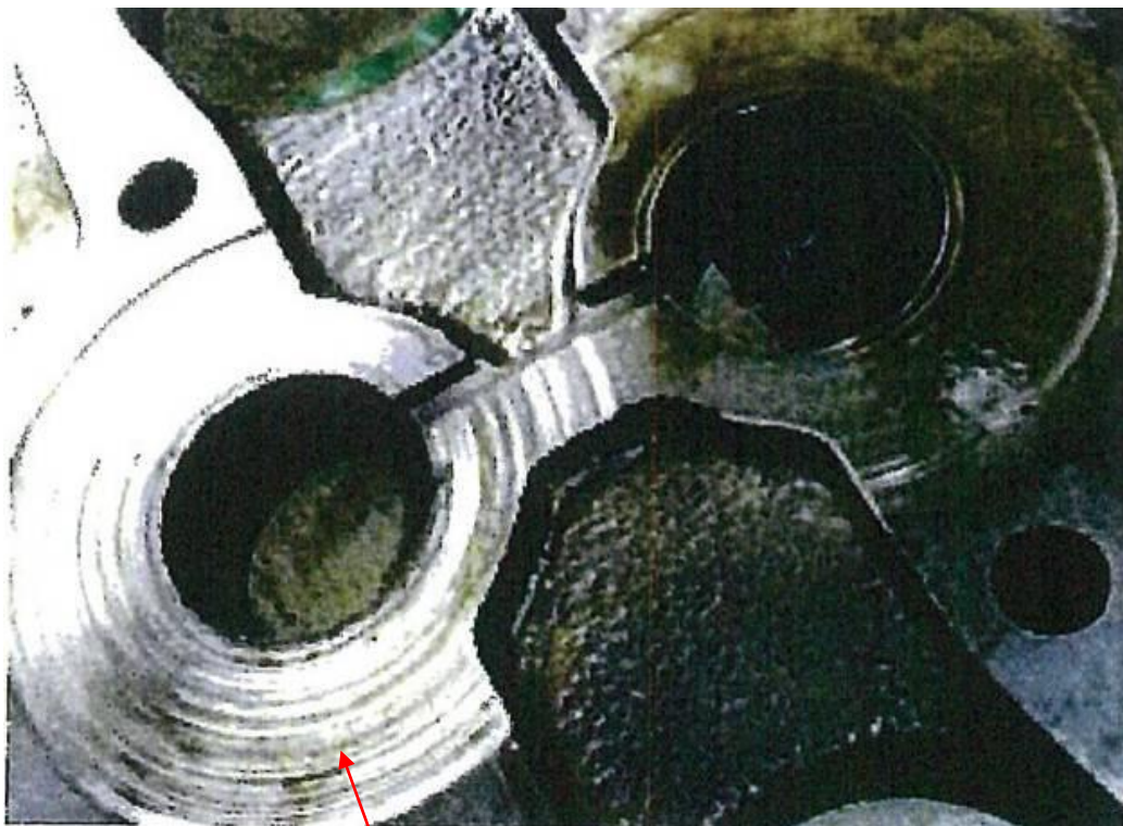
写真3 潤滑油ポンプのケーシングに付いた段付き摩耗の状況
