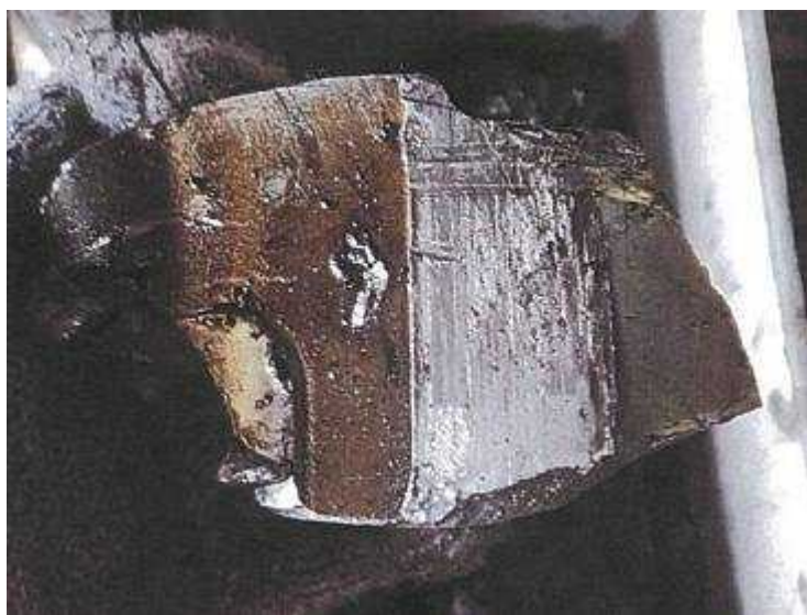
写真1 6番シリンダのピストン割損状況
