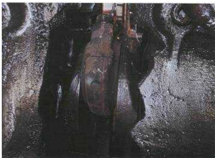
写真2 6番シリンダのシリンダブロック破口状況
