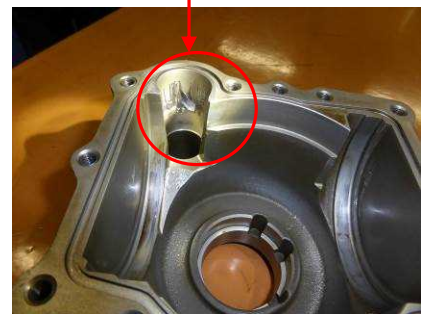
写真2 ケーシング内損傷状況
