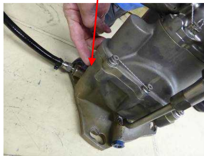
写真1 プライマリーポンプ
