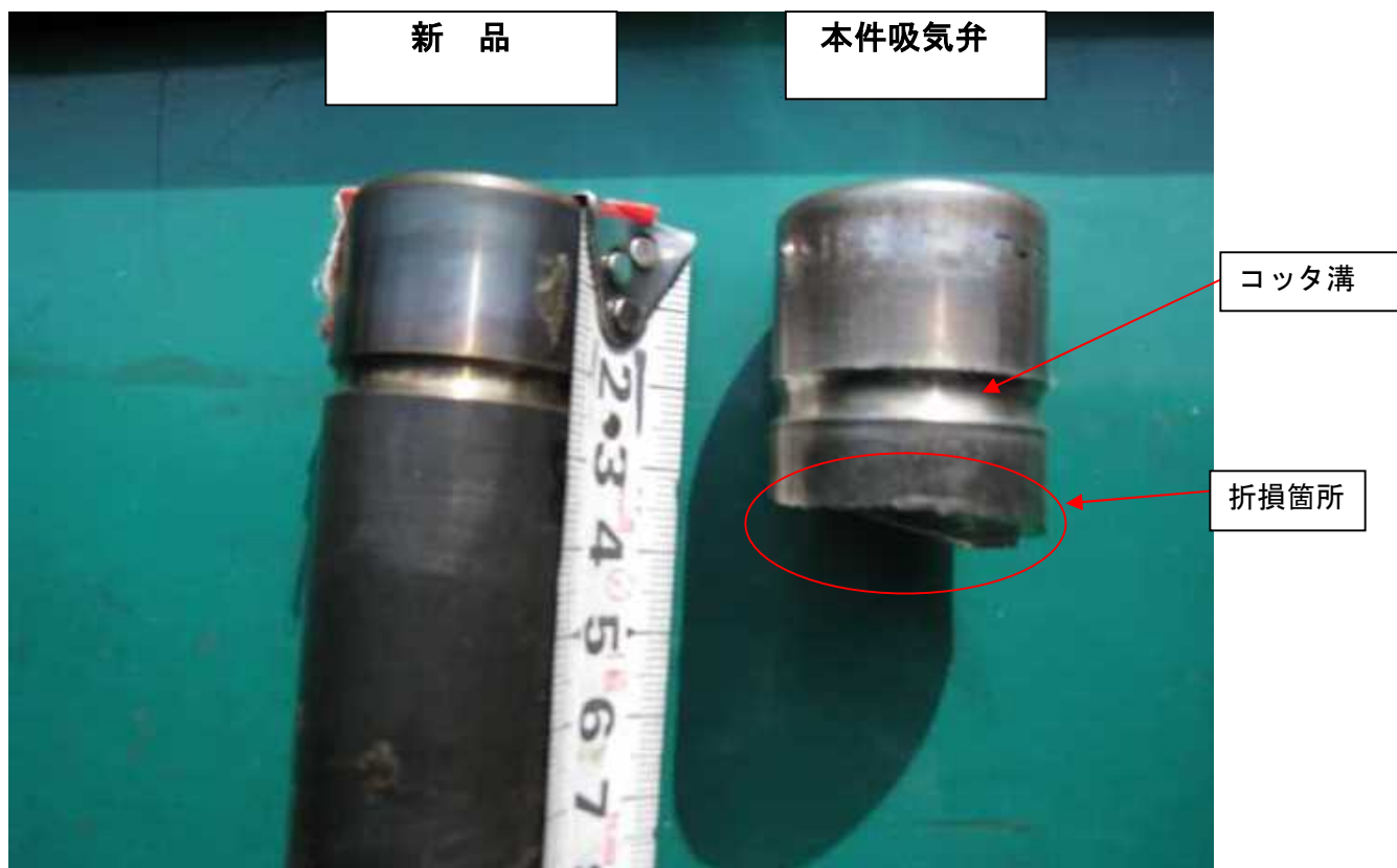
写真2 本件吸気弁の折損状況及び新品
