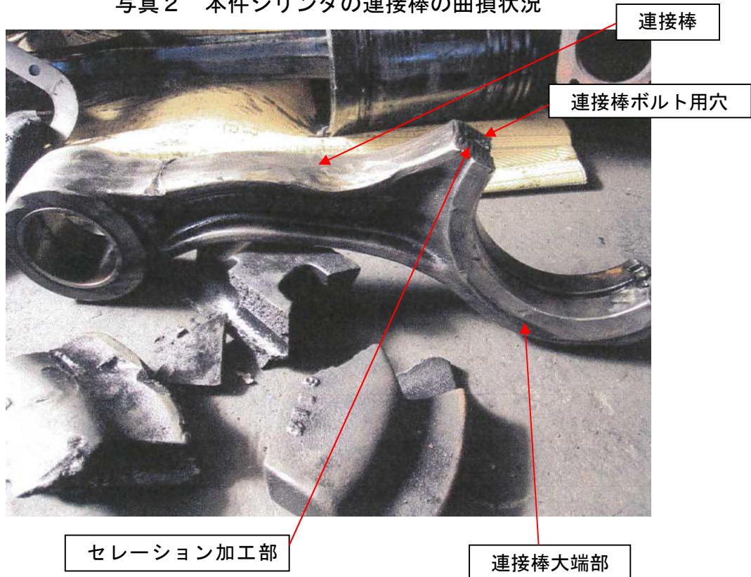
写真2 本件シリンダの接続棒の曲損状況
